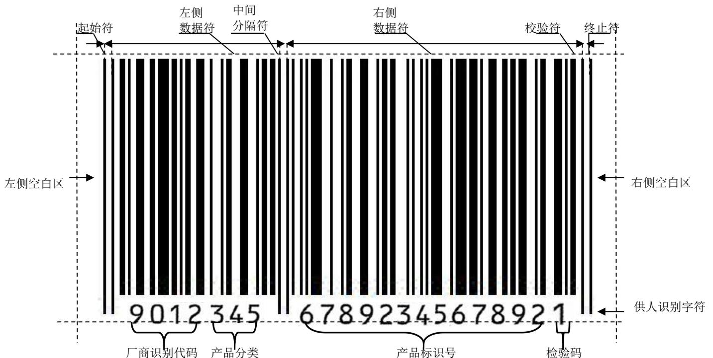
图2 条码的符号结构
